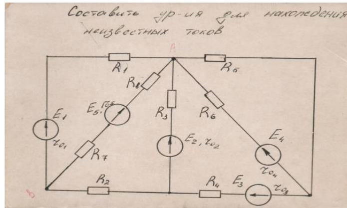
4. Задача на расчет разветвленной цепи однофазного переменного тока.
