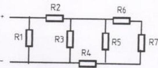
**Дано:**  $R_1=6 \text{ Ом}; R_2=10 \text{ Ом}; R_3=3 \text{ Ом};$
